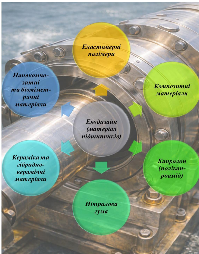
Рисунок 1 – Екодизайн. Класифікація ПКМ суднових підшипників
