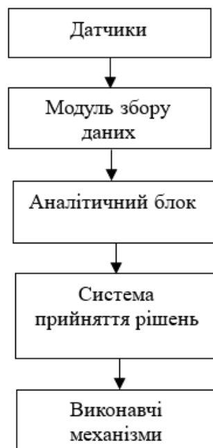
Рисунок 1 – Структура автоматизованої системи управління судном
