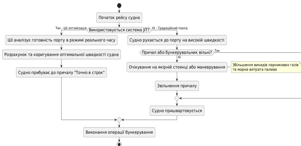
Рисунок 2 – Порівняння традиційного процесу заходу судна в порт бункерування та альтернативного варіанту «Just in Time»
