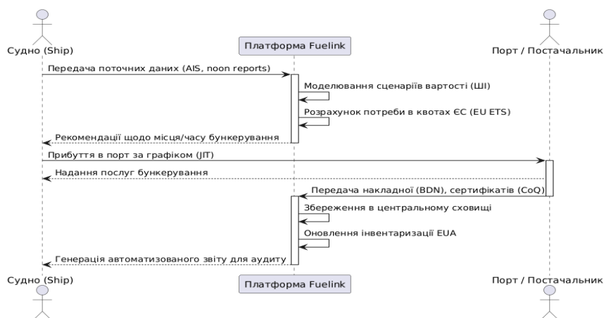
Рисунок 1 – Послідовність обміну даними під час операцій з бункерування із застосуванням системи Fuelink
