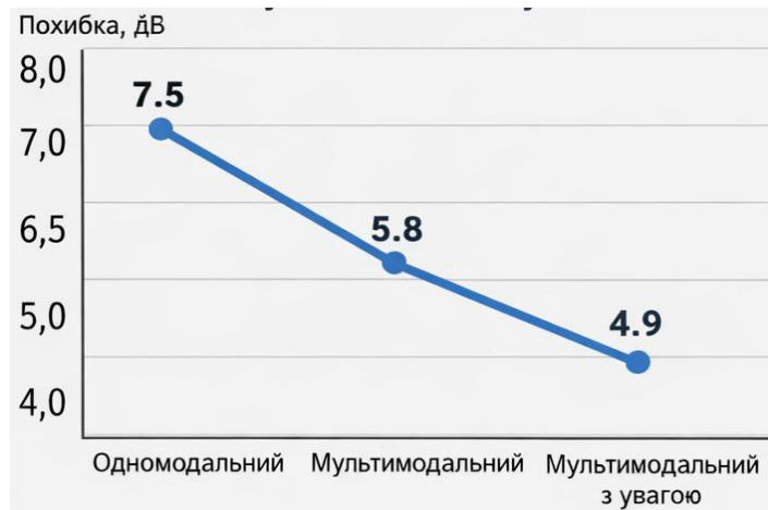
Рисунок 2 – Похибка оцінювання параметрів акустичного каналу
